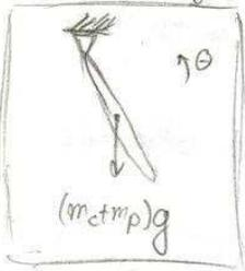
Sea  $m_p = 80 \text{ kg}$  la masa del piloto. Se tienen las mismas condiciones que en el vehículo solo. Del DCL del sistema vehículo-piloto se tiene que:  $-(m_c + m_p)g \frac{L}{2} \sin \theta = (I_A + m_p (\frac{L}{2})^2) \ddot{\theta}$  (se considera al piloto en el centro del vehículo)
