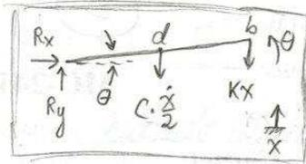
Se toman los sistemas de coordenadas que se muestran en la figura. Por semejanza de triángulos,  $x_d = \frac{x}{2}$  ( $x = x_b$ ) por lo que  $\dot{x}_d = \frac{\dot{x}}{2}$ . Tomando momento en el
